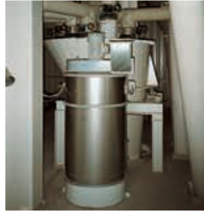
Flanged connection for top-mounted fan or centralized suction Flanschstützen für oben montierten Ventilator bzw. für zentrale Absaugung Raccord pour aspirateur supérieur ou aspiration centralisée Raccordo per aspiratore superiore o per aspirazione centralizzata
