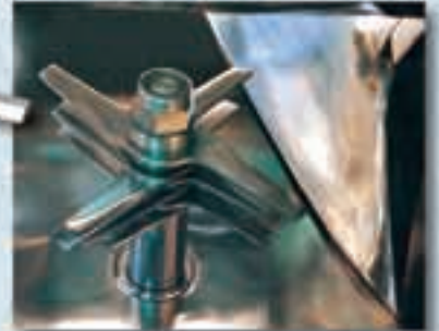
Blade-Type Chopper Mehrfachmesserkopf Chopper à lames Chopper a lame
